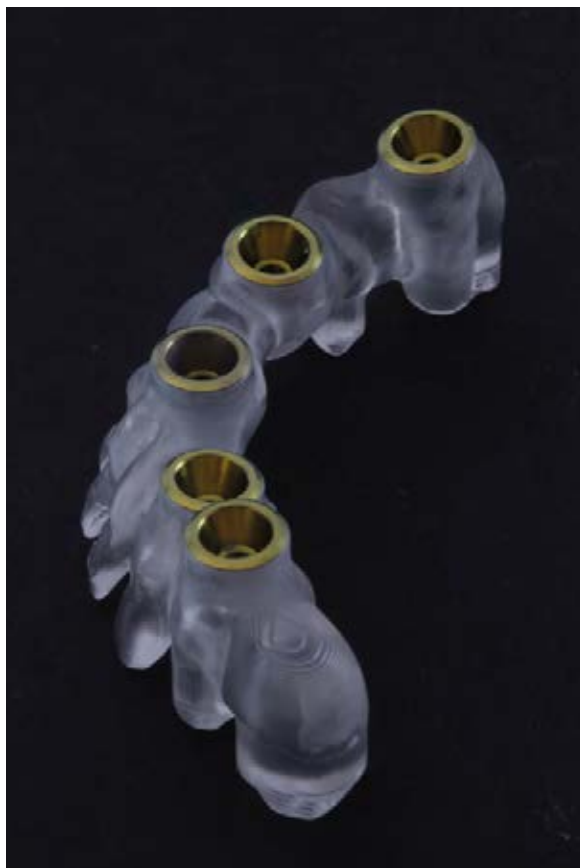
Estructura hecha de PMMA dopada de grafeno.
