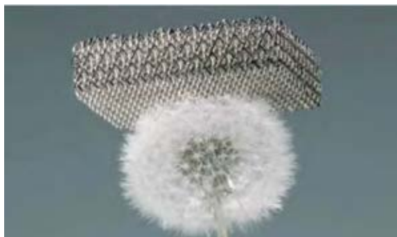
Microlattice sobre un diente de león para mostrar su ligereza.
